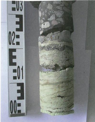
Bild 21. Bohrung B 2 – Harz in der ungebundenen Tragschicht und darunter praktisch ohne Fremdbestandteile
