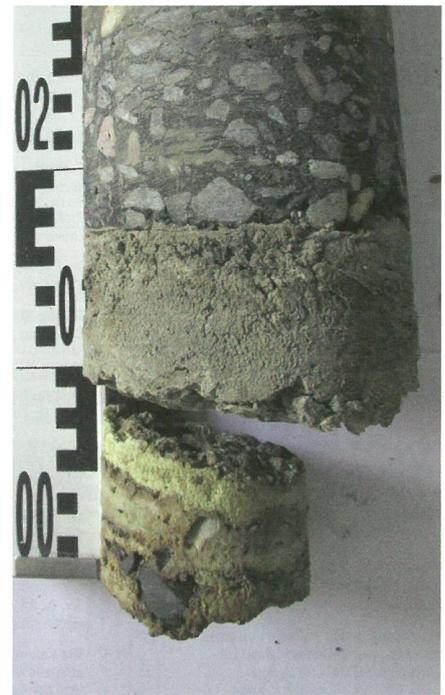
Bild 25. Bohrung B 3 – Harz unterhalb des Asphalts mit Sand- und Brechkornanteil
