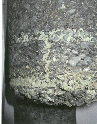
Bild 22. Bohrung B 9 – Harz in den Asphalt-schichten
