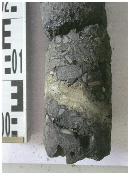
Bild 24. Bohrung B 9 – Harz in den Asphalt-schichten
